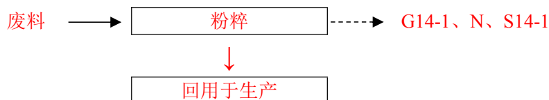
图 3.7-18 废膜回收利用生产工艺流程产污节点图
