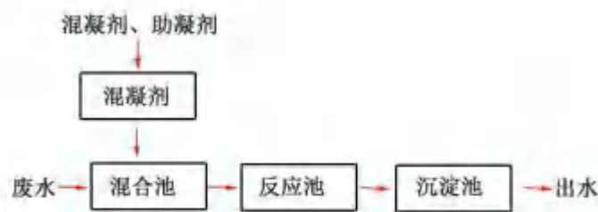
图6.2-5 混凝沉淀工艺流程图
