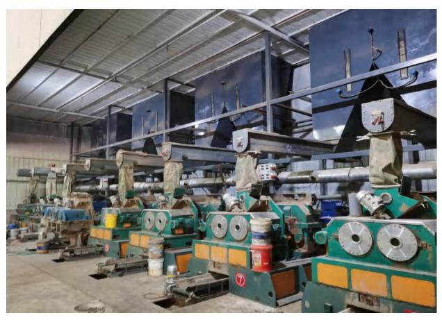
制粒机机废气收集设施
