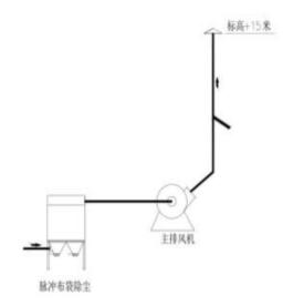
粉尘车间将车间废气通过管道引入到设备的脉冲除尘器,经过除尘器将废气 充分过滤,过滤出废气中的灰尘及其他颗粒物,最终达标排放。
