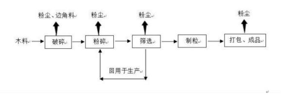
图 2-2 木屑颗粒主要生产工艺流程图
